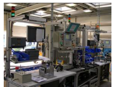
Linie für die Montage von Hand von Pumpen
